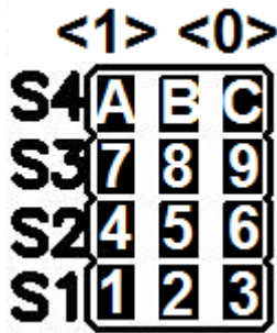
Рисунок 3.1.2 – Перемычки режимов работы платы управления
