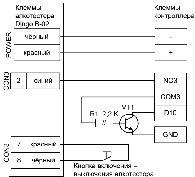
Рисунок 26. Вариант 1 подключения алкотестера Динго В-02 к двери.
